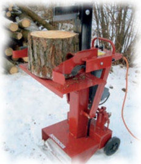
Die robuste und ausgereifte Technik mit den Anlenkpunkten unten sorgt für eine hohe und sichere Arbeitsleistung.
