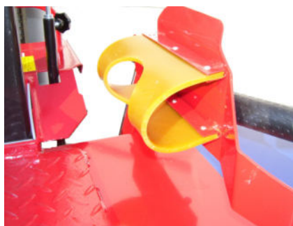
Gummipuffer dämpfen den seitlich entstehenden Spaltdruck
