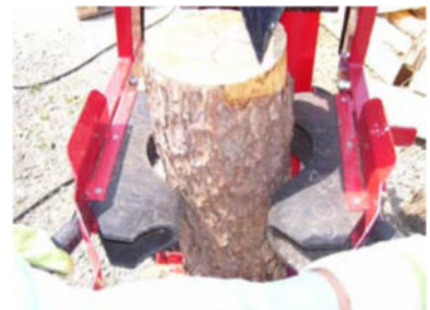
Schiebetechnik mit Gummidämpfung
