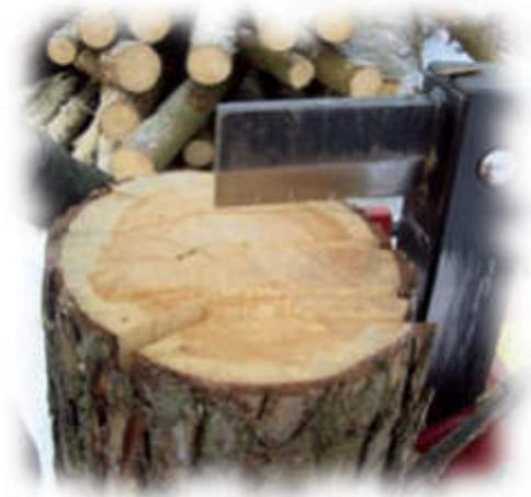
*stabiles Spaltmesser aus Spezialstahl für härtesten Einsatz*
