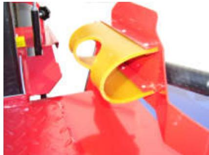
*Gummipuffer dämpfen den seitlich entstehenden Spaltdruck*
