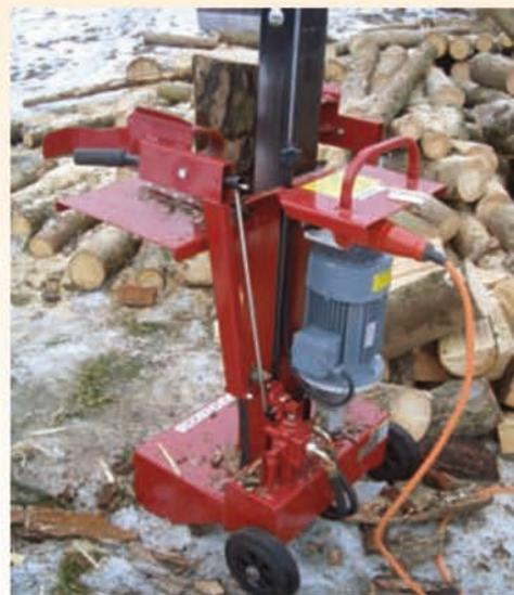
*Ein leistungsstarker E-Motor mit einer hochwertigen Hydraulikpumpe bringt zuverlässige Spaltkraft.*
