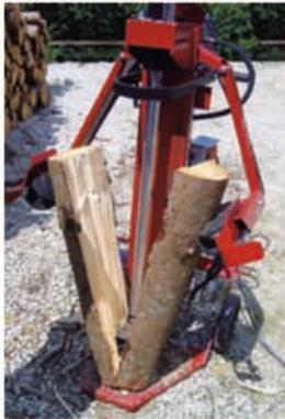
**Stufe 1** ermöglicht eine enorme Spaltkraft, während **Stufe 2** die Spaltgeschwindigkeit erhöht.
