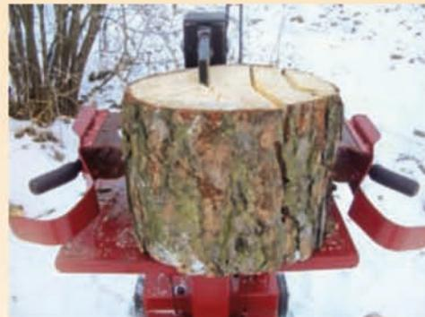
*Ergonomische Haltegriffe mit Gummipuffern die den seitlichen Spaltdruck aufnehmen.*
