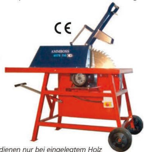
*Zu bedienen nur bei eingelegtem Holz mit geschlossenem Sicherheitsbügel*
