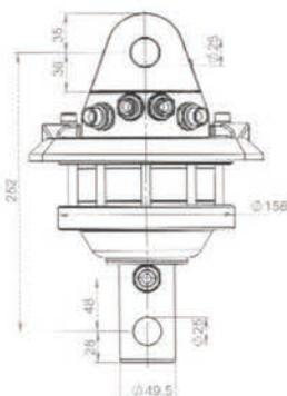
Der Rotator für kleine Stückgutkräne und Minibagger, Frontlader, Radlader, Hoflader, Forstkräne, Ladekräne usw. - Rotation endlos drehbar
