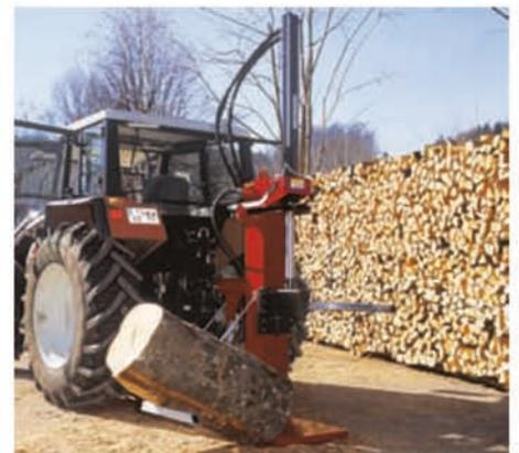
Abb.: Mit mechanischem Stammheber, der zugleich auch als Ablagebügel genutzt werden kann.
