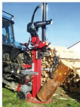
H 125 mit Aufbauwinde, Holzaufstellen direkt unter's Spaltmesser
