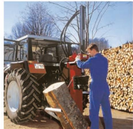
Abb.: Mit mechanischem Stammheber und Schaltung oben (Zubehör).
