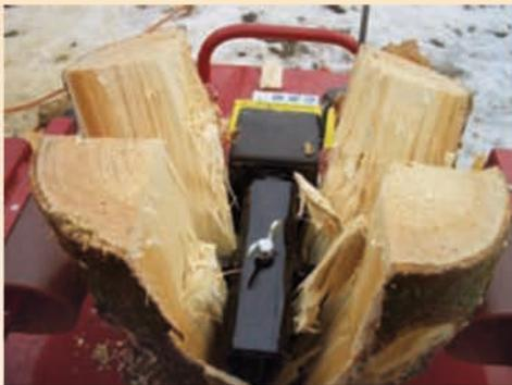
*Das aufschiebbare Spaltkreuz spaltet in einem Arbeitsgang das Holz in 4 Teile.*
