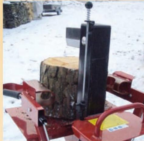
*Stufenlose Höhenverstellung durch Stange mit Rändelschraube. Transportgriff abgerundet.*
