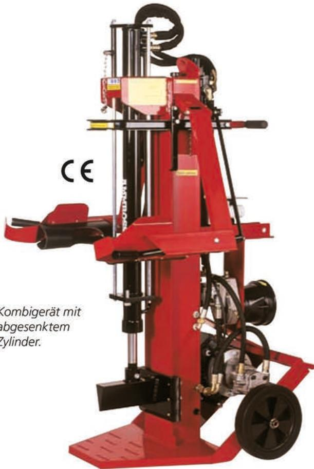
Abb.: Kombigerät mit abgesenktem Zylinder.
