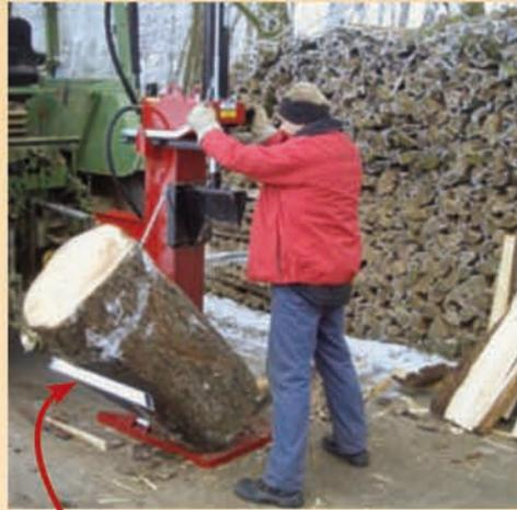
Stammheber mechanisch oder hydraulisch
