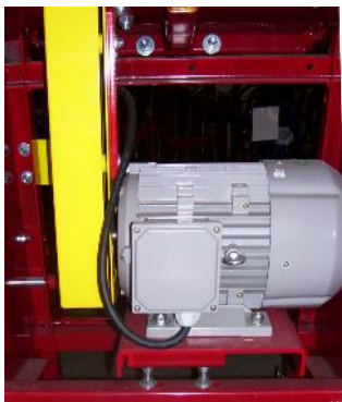
Keilriemenantrieb und Spezial-Kreissägenmotor
